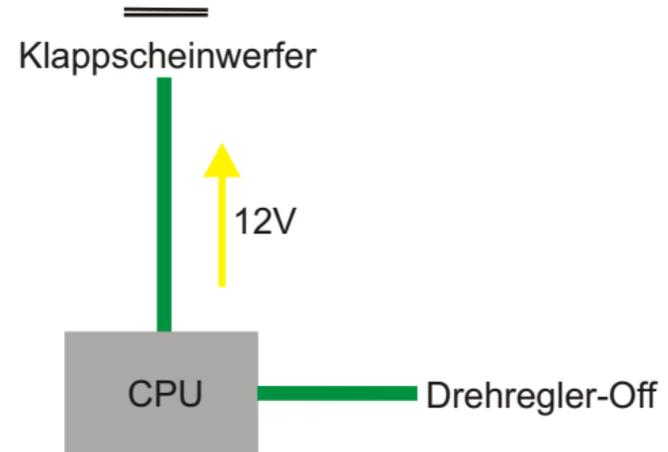
Schalter auf Off ...Dauerstrom zum Stellmotor bis Klappie unten...dort wieder ein Endabschalter.
