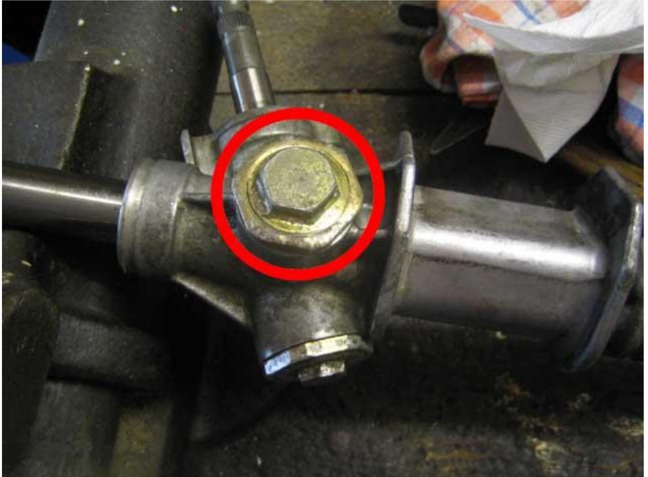
Im folgenden Bild ist sieht man noch die Feder und die darunter liegende Druckplatte. Die Druckplatte kann einfach rausgedrückt werden wenn später die Zahnstange aus dem Gehäuse genommen wird. Die eingekreiste Schraube hält die Lenkspindel im Getriebe. Diese also auch entfernen indem man die grosse Kontermutter löst:
