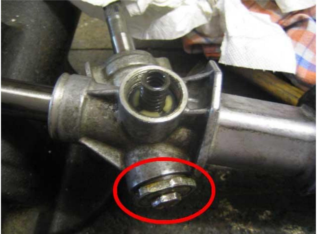
Jetzt kann die Lenkspindel nach unten rausgedrückt/gezogen werden. Das ist etwas hakelig. Am Besten bewegt man die Zahnstange im Gehäuse während man die Lenkspindel leicht dreht und dabei versucht sie rauszudrücken/rauszuziehen:
