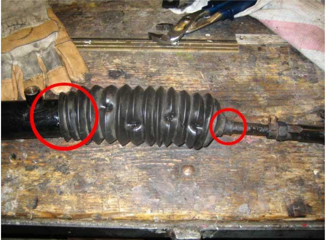
Dann müssen die Nasen der Sicherungsscheibe von der Spurstange aufgebogen werden:
