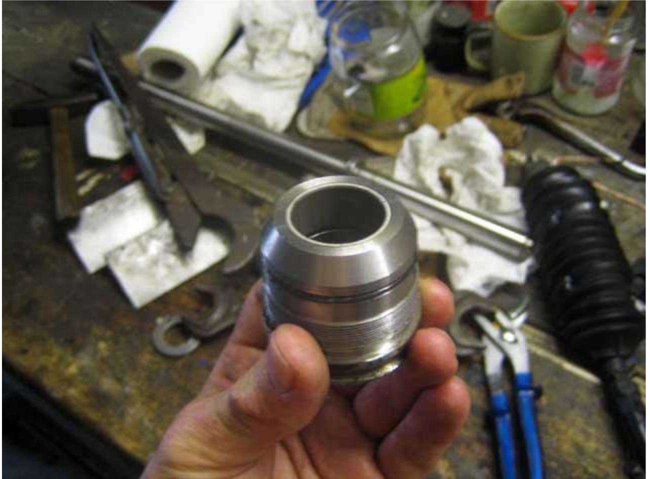
Auf der Getriebeseite (Fahrerseite) ist ein Aluring eingepresst. Dahinter sitzt ein Plastikring. Ich habe den Aluring entfernt indem ich erstmal die Zahnstange komplett ins Gehäuse gekurbelt habe. Dann habe ich einen flachen Schraubenzieher hinter den Aluring geklemmt (also zwischen Aluring und Plastikring) und dann die Zahnstange wieder rausgekurbelt. Weil der Schraubenzieher hinter den Aluring geklemmt ist wird er aus dem Gehäuse gedrückt. Hier ein Bild von beiden Teilen:
