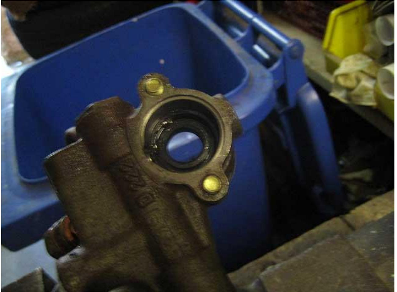
Jetzt einfach mit einem breiten Werkzeug oder Rohr (wie im Bild) den Deckel mit Dichtung herausschlagen:
