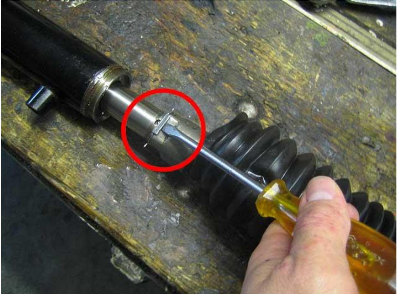
Die Spurstange kann jetzt von der Lenkstange/Zahnstange abgeschraubt werden:
