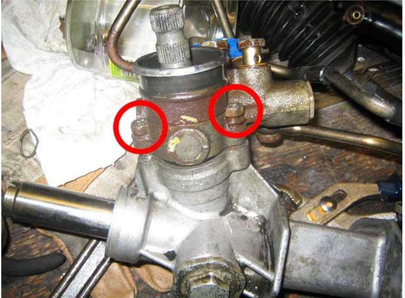
Darunter liegt ein weisser Plastikring, der entnommen werden kann. Das Lager darunter löst sich wenn man die Lenkspindel entfernt.
