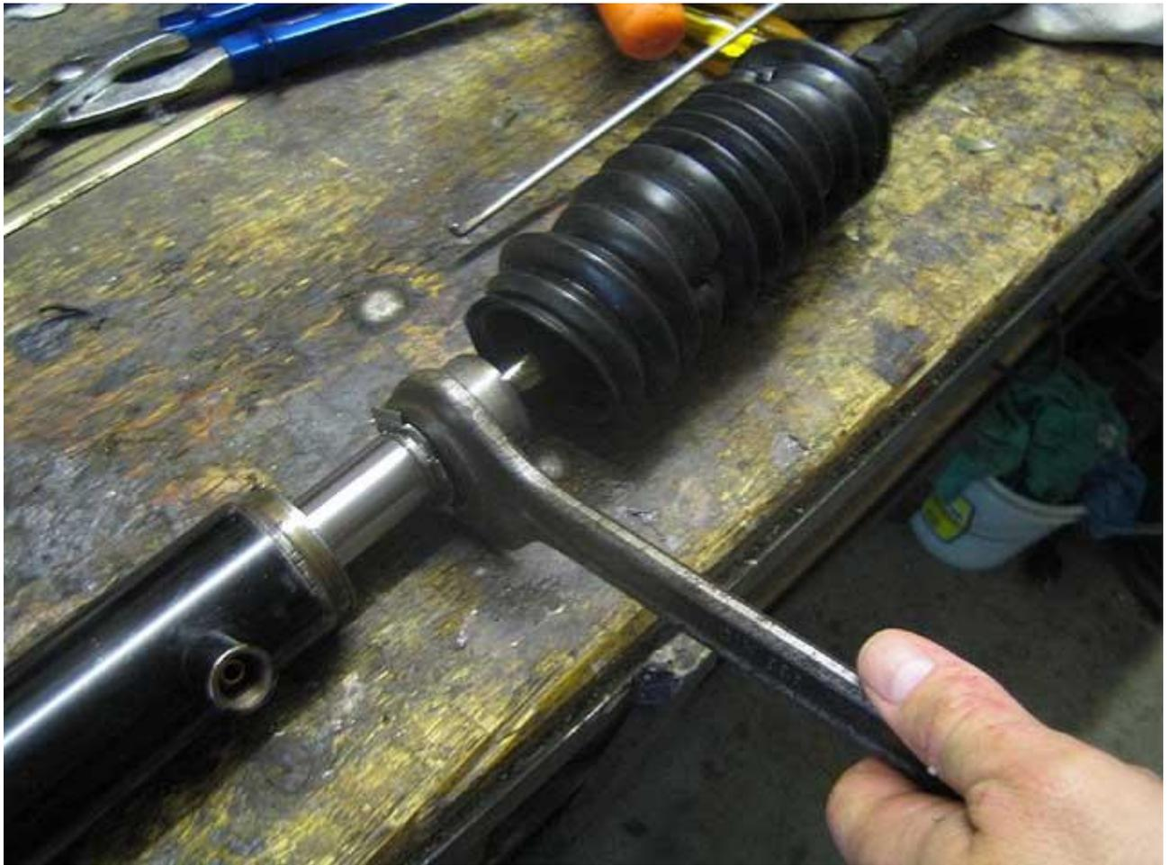
Um das Gehäuse auf der Beifahrerseite aufschrauben zu können wird eigentlich ein Spezialwerkzeug benötigt (laut Werkstatthandbuch: Drehmomentschlüsseladapter T88C-3504-CH). Ich habe es geöffnet, indem ich zwei passende Durchschläge in die Löcher gesetzt und dann mit einem Schraubenzieher, den ich dazwischen verkeilte, aufgedreht habe. Dazu muss natürlich die Zahnstange ins Gehäuse gekurbelt werden ;).
