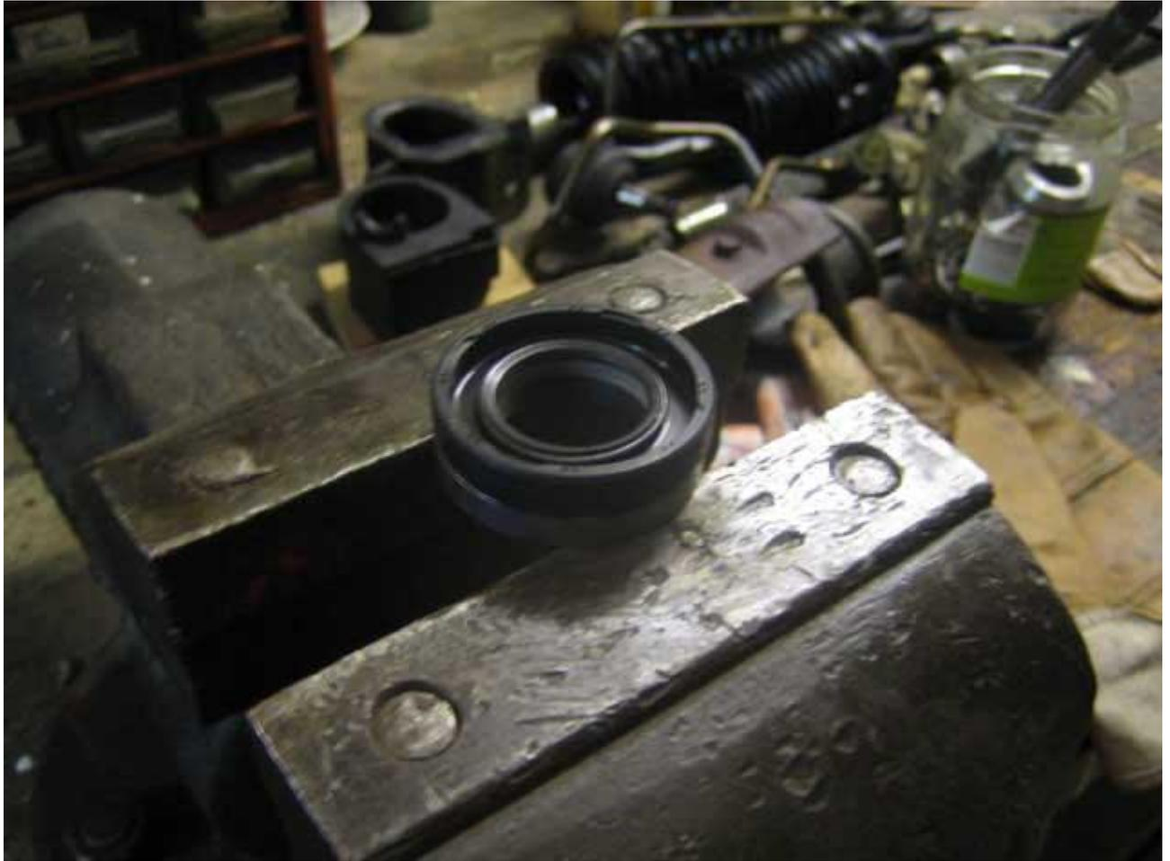
Und falls jetzt einer fragt: "Warum hast du nicht das Gehäuse selbst noch auseinander genommen um an die Dichtung zu kommen ?" Das liegt daran, dass beide Teile - Aluteil vom Getriebe und Metallrohr - miteinander an zwei Stellen verstemmt sind. Der Pfeil zeigt auf eine Stelle:
